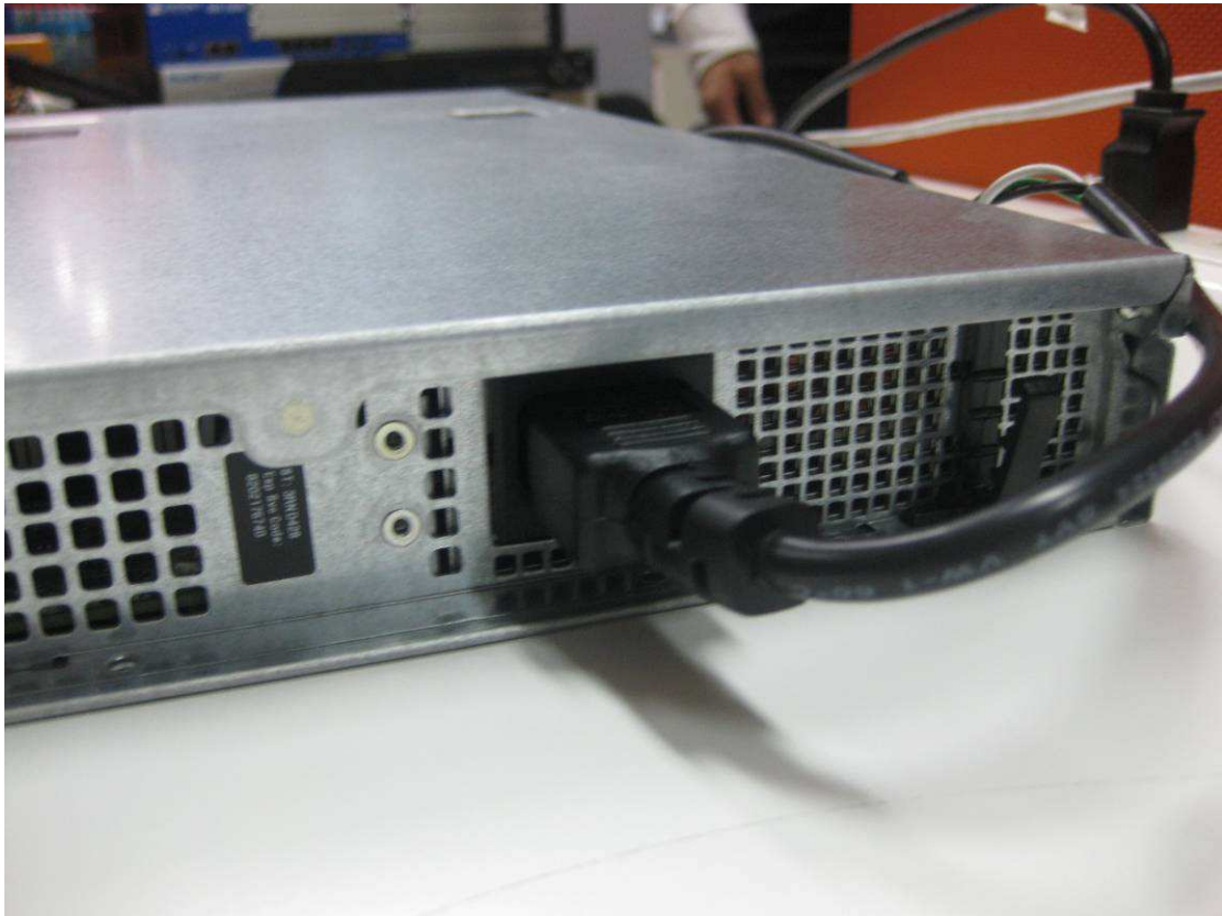
- เสียบปลั๊กเข้ากับอุปกรณ์ i-Secure L120 (Logger)
