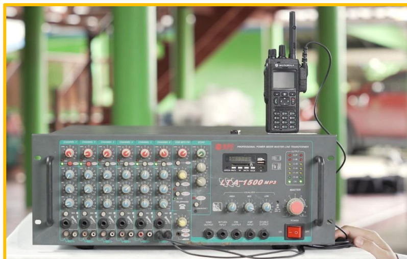
รูปที่ 8 รูปแบบการเชื่อมต่อสาย Audio กับเครื่องขยายเสียง เมื่อติดตั้งเสร็จสิ้น
