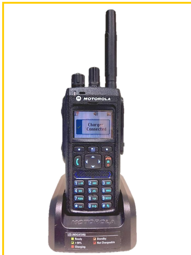
รูปที่ 2 รูปแบบการชาร์จเครื่องวิทยุสื่อสาร แบบเสียบชาร์จบนแท่นชาร์จหลัก
