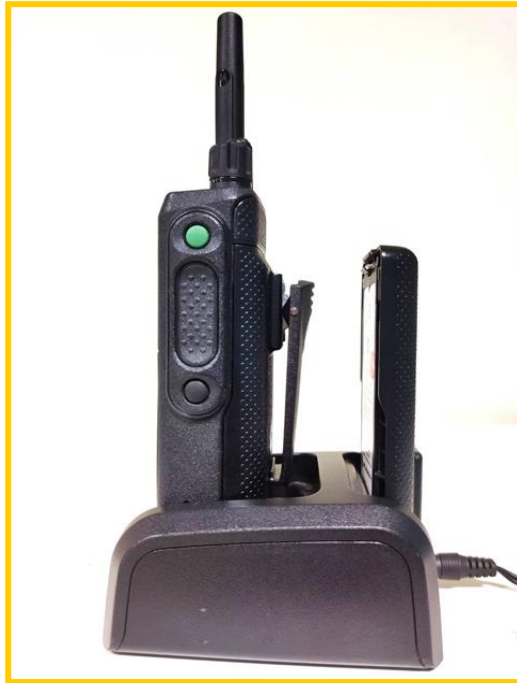
รูปที่ 3 รูปแบบการชาร์จเครื่องวิทยุสื่อสาร แบบเสียบชาร์จบนแท่นหลัก และสำรอง
